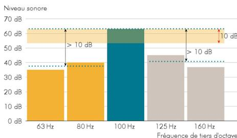
1. Cas d'une tonalité marquée à 100 Hz car les moyennes énergétiques des niveaux aux fréquences de 63 et 80 Hz, d'une part, et à celles de 125 et 160 Hz, d'autre part, sont différentes de plus de 10 dB à la valeur à 100 Hz.
